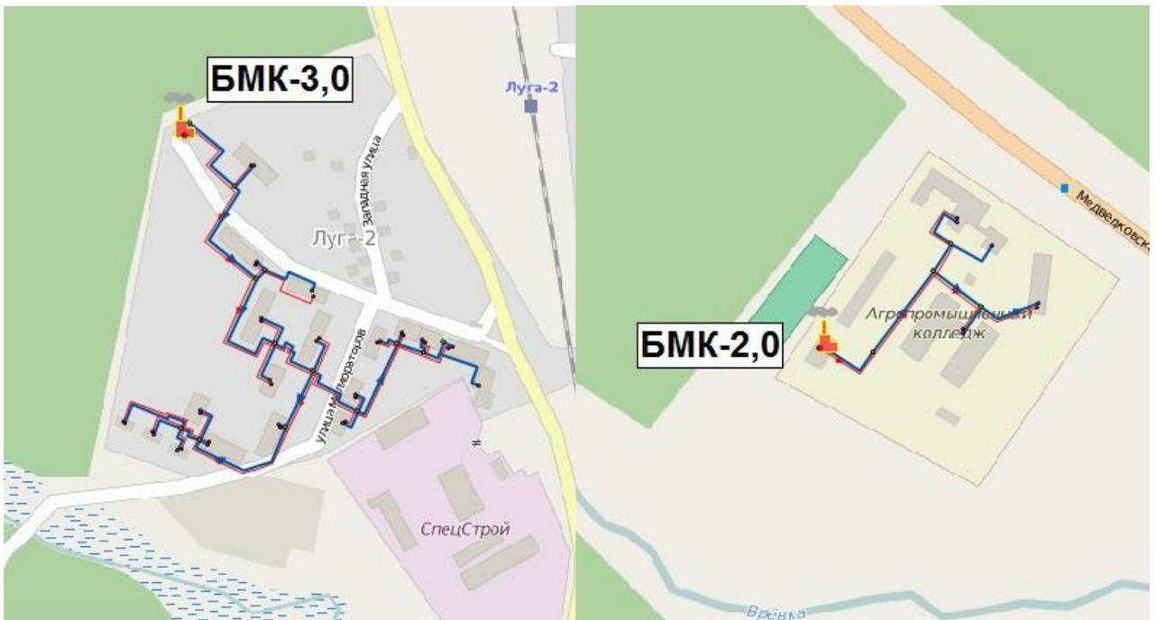
Рисунок 13 - Тепловые сети котельных БМК-2,0 МВт и БМК-3,0 МВт
